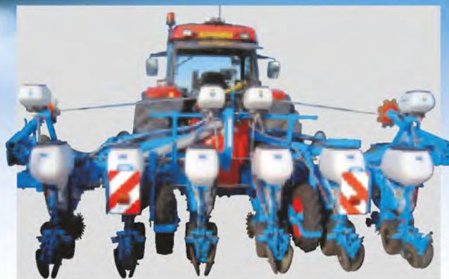
6-reihige klappbare Einzelkornsämaschine (Reihenabstand 75 cm)
