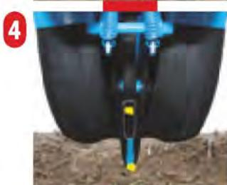
**4** Das gekrümmte Saatführungsrohr wurde speziell geformt, um die Körner sanft und mit hoher Genauigkeit in den Boden zu legen.
