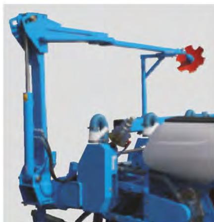
Doppelklappbare Spuranzeiger für bis zu 12-reihige Sämaschine
