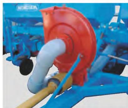
Die durch eine Weitwinkelgelenkwelle angetriebene Turbine erlaubt, unabhängig vom Hydrauliksystem, die Sämaschine an jedem Traktor anzubauen.
