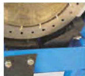
Die Zellen der Aussaatüberwachung sind unter den Gehäusen der Elemente angeordnet. Ein Lichtstrahl erlaubt, den Durchgang der Saatkörner zu kontrollieren, sogar die kleinsten.
