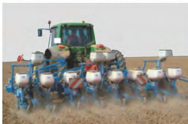
8-reihige klappbare Einzelkornsämaschine (Reihenabstand 80 cm)
