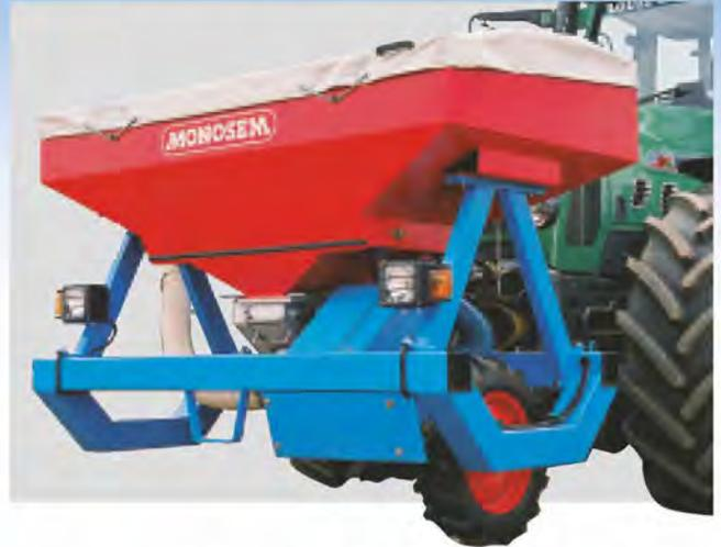
Der MONOSEM Frontdüngerbehälter wurde speziell für das Ausbringen von granuliertem Kunstdünger entwickelt. Der Behälter weist einen extra stabilen Rahmen auf, auf dem er auch abgestellt werden kann. Das Streuwerk besteht aus 100%ig rostfreiem Stahl und wird durch ein Antriebsrad mit großem Durchmesser angetrieben.
