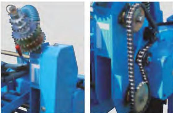
Das Wechselradgetriebe erlaubt eine schnelle und präzise Einstellung der Saatstärke.
