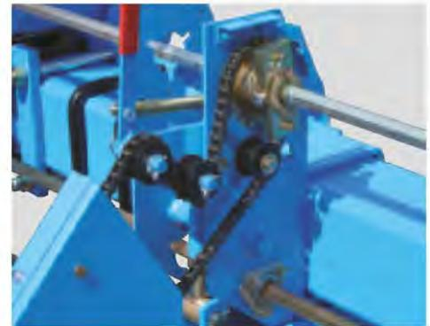
Das Getriebe ist mit verstärkten Ketten und einer Sicherheitskupplung ausgestattet.
