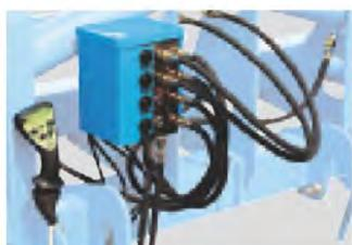
Der mit einer elektrischen Steuerung ausgestattete Multifunktionsmonitor (Option) erlaubt, über ein mechanisches doppelwirkendes Steuergerät, alle Funktionen der Sämaschine einfach zu bedienen.
