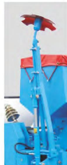
Spuranzeiger für 4-reihige Sämaschine
