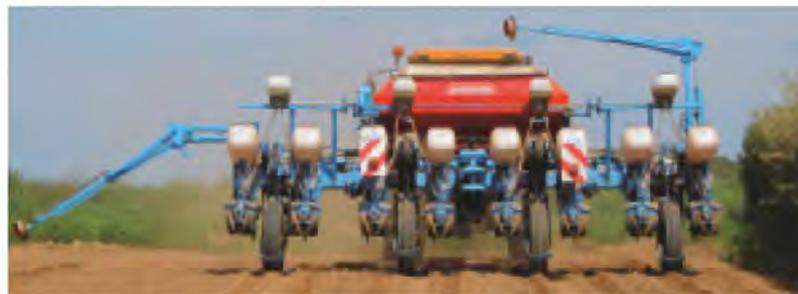
Die 8-reihige, gezogene klappbare WingFold-Sämaschine verfügt über hydraulische Stützrädlerblöcke, die einen optimalen Bodenabstand sowie hohe Stabilität am Vorgewende gewährleisten.
