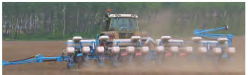
Gezogene 12-reihige WingFold Flex-Sämaschine mit Düngestreuer (76,2 cm Reihenabstand)
