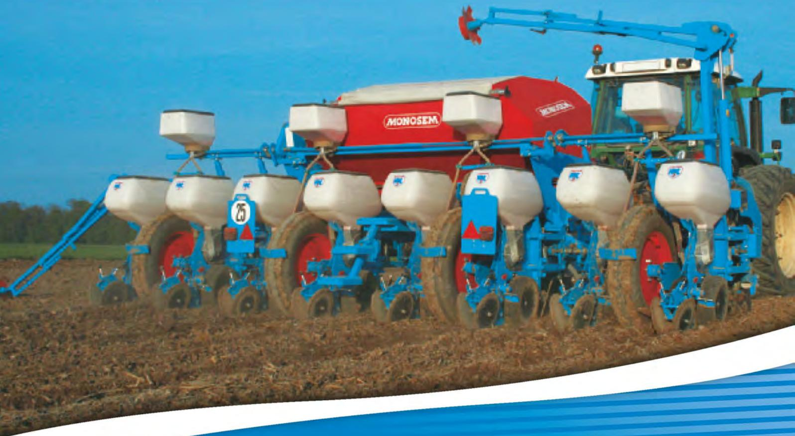
*Pneumatisches Sägerät mit Doppelscheiben*
