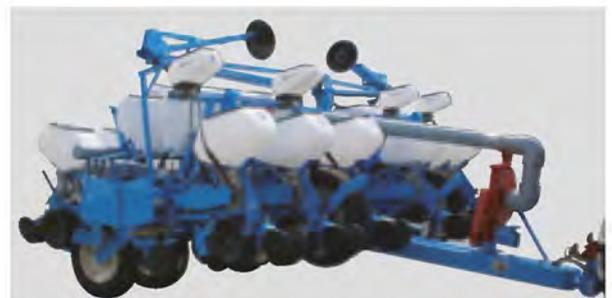
Gezogene 12-reihige WingFold Flex-Sämaschine mit Düngestreuer in Transportstellung
