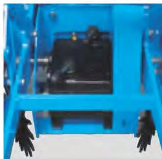
Zur raschen und präzisen Einstellung der Aussaatdosierung ist die gezogene klappbare WingFold-Sämaschine mit einem Schaltgetriebe ausgestattet.
