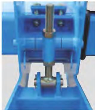
Die höhenstellbaren Radblöcke sichern den Sä-Elementen eine optimale Arbeitsposition.
