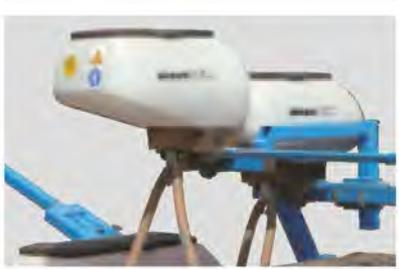
Die Microsem für Insektizide und die Microsem für Schneckenkorn können für die gleichzeitige Ausbringung der 2 Produkte verbunden werden.
