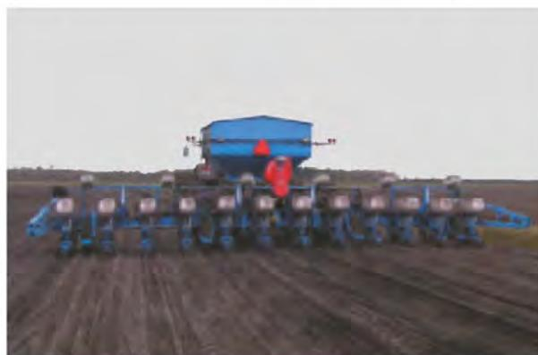
12-reihige klappbare Einzelkornsämaschine (Reihenabstand 75 cm)
