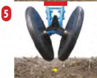
**5** Das Druckrollenaggregat, bestehend aus 2 V-förmigen Rollen, schließt die Furchen rund um das Korn und sichert so eine optimale Keimung.
