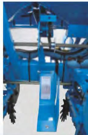
Die **Einstellung der bei der Aussaat gebrauchten Düngerdosierung**, erfolgt über ein **12-gängiges Schaltgetriebe**.
