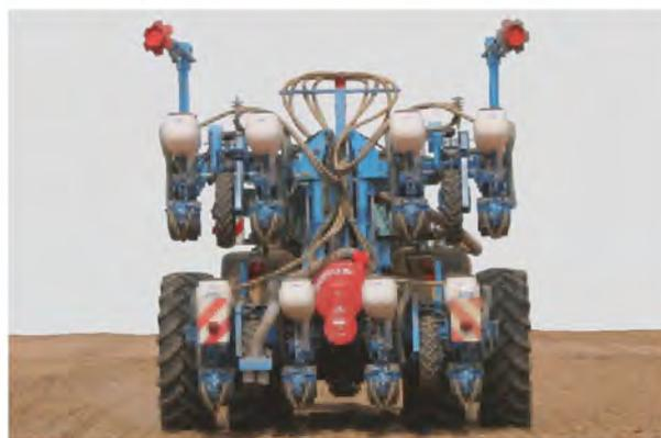
8-reihige Einzelkornsämaschine (In Transportstellung klappbar)
