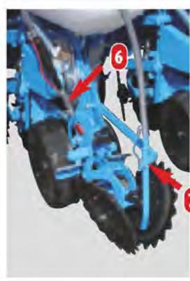
Die Insektizide werden durch ein Rohr (6) zwischen den beiden Scheibenscharen in die Aussaatreihe gebracht. Für Schneckenkorn kann das Rohr (7) an verschiedenen Stellen des Sägerätes angebracht werden, um das Mittel vor oder nach den Andruckrollen auszubringen.
