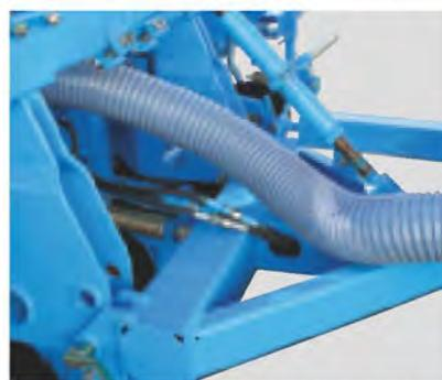
Die auf den 3-Punktlaschen der Sämaschine anbaubare Deichsel, ist in der Höhe verstellbar. So lässt sich die Einzelkornsämaschine einfach und schnell an jeden Traktor anpassen.
