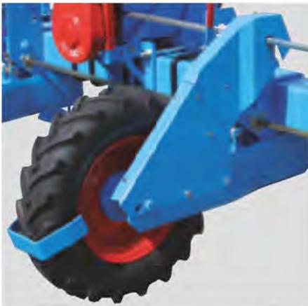
Das Getriebe der NX-Einzelkornsämaschinen ist mit Schutzhauben versehen. So wird bei Begrünung oder Pflanzenrückständen ein lückenloser Einsatz gewährleistet.
