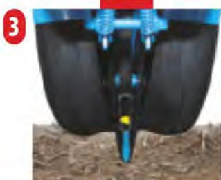
**3** Die Doppelscheiben öffnen die Furche auf einer durch die Druckrollen bestimmten Tiefe. Die Scharspitze bereitet den Furchenboden zur optimalen Saatkornablage.
