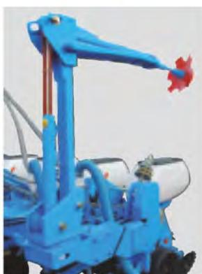
Die schwenkbaren Spuranzeiger der 8-reihigen NX-Einzelkornsämaschine erlauben ein enges Zusammenklappen und eine kompakte Transportbreite.
