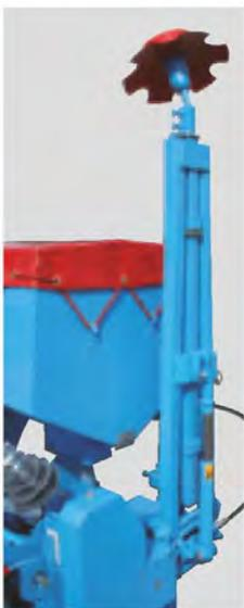
Spuranzeiger für 6- und 8-reihige Sämaschinen
