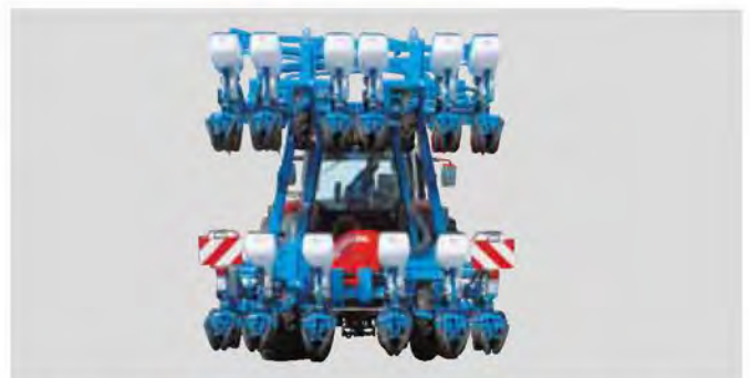
Das mittlere Teil des Rahmens besteht aus einem teleskopischen Doppelbalken. Die Seitenteile sind teleskopisch und klappbar. Das Gesamte lässt sich (je nach Ausstattung) auf eine Transportbreite von 3 m zusammenklappen.
