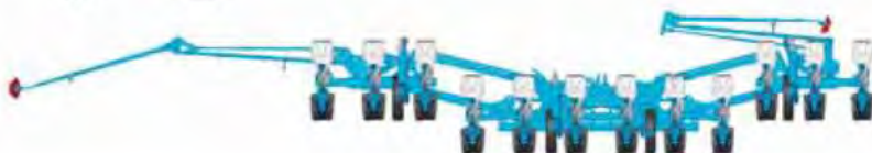
Das mittlere Teil des Rahmens besteht aus einem teleskopischen Doppelbalken. Die Seitenteile sind teleskopisch und klappbar. Das Gesamte lässt sich (je nach Ausstattung) auf eine Transportbreite von 3 m zusammenklappen.
