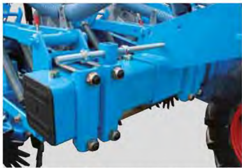
Anschlüsse auf dem Teleskopsystem erlauben eine perfekte Einstellung der Reihenweite und gleichmäßiges Zusammenschieben.
