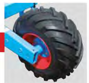
Verstärkte Andruckrolleneinheit mit 26x12-Rolle
