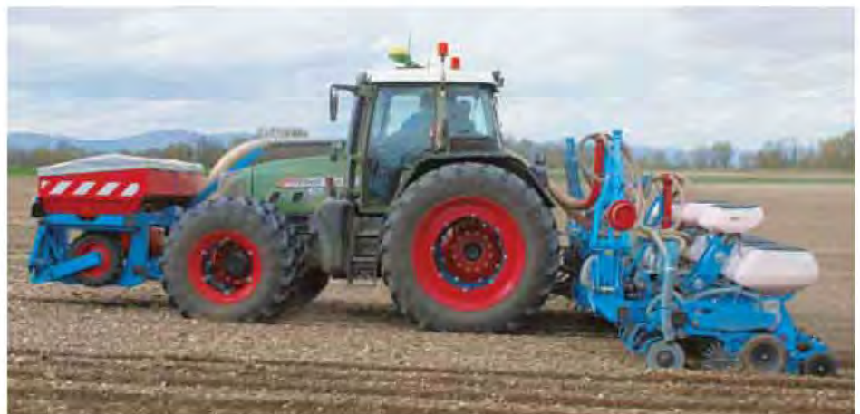
Bis zu 4 Standard-Düngerstreuer (4 x 270 L), ein Frontdüngerstreuer oder ein DUO-Frontdüngerstreuer lassen sich auf den CRT-Rahmen bauen. In dieser Ausführung ist die Sämaschine mit zwei Dosierungsköpfen ausgestattet (Montage je nach Ausstattung und Reihenabstand).
