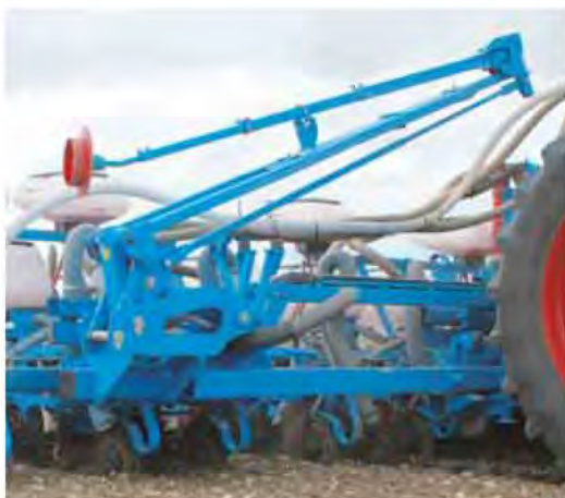
Die auf das Rad oder die Traktormitte einstellbaren Spuranzeiger erlauben ein dichtes Zusammenklappen und eine kompakte Transportbreite. Sie verfügen ebenfalls über eine Anfahrssicherung.
