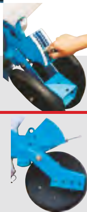
NC Technic-Element für Mais mit Doppelscheibenschar & seitlichen Tiefenführungsrollen (Tandemführung)
