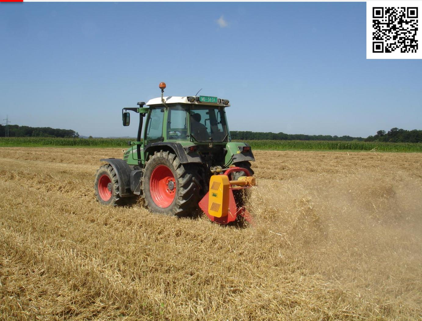
Mulčer MS se uporablja v poljedelstvu za drobljenje slame od pšenice, ječmena, soje... Visoki vrtljaji rotorja (3000 obr/min) ter minimalna zračnost med noži in protinoži zagotavljajo kvalitetno drobljenje in raztros mase do širine 12 metrov.
