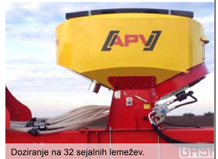
Ta dozirni sistem zagotavlja natančno prečno porazdelitev pri 16 izstopnih odprtinah.
