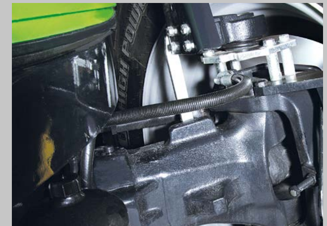
Vorderachse. Maximaler Federeffekt und ein Lenkeinschlagswinkel von bis zu 50 Grad.
