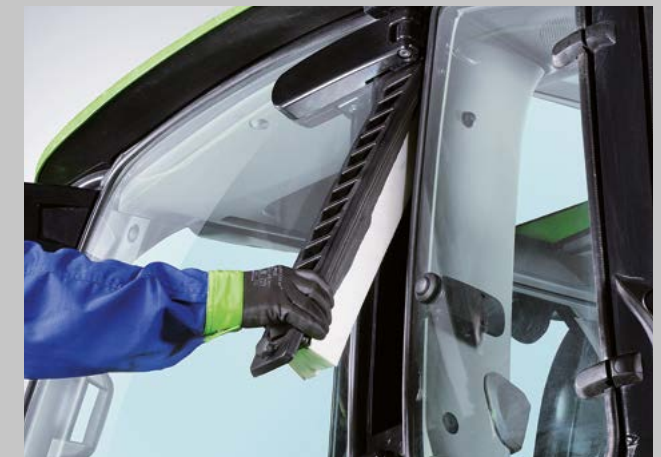
Der Kabinenluftfilter in der Kabinensäule ist einfach und werkzeuglos zugänglich.
