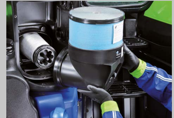
Auch für den Austausch der Motorluftfilter wird kein Werkzeug benötigt.
