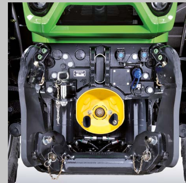
Integrierter Frontkraftheber mit einzigartig kurzer Distanz zur Frontachse. Geringer Überhang. Beste Traktor-Balance.
