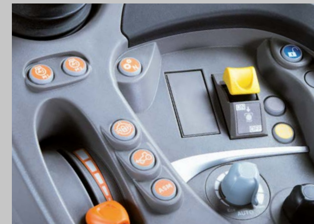
Die Zapfwelleneinstellung und -Aktivierung sind griffgünstig in die Armlehne integriert ...
