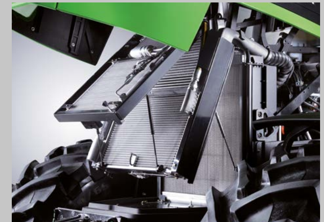
Der Motorkühler ist einfach aufzuklappen und leicht zu reinigen.
