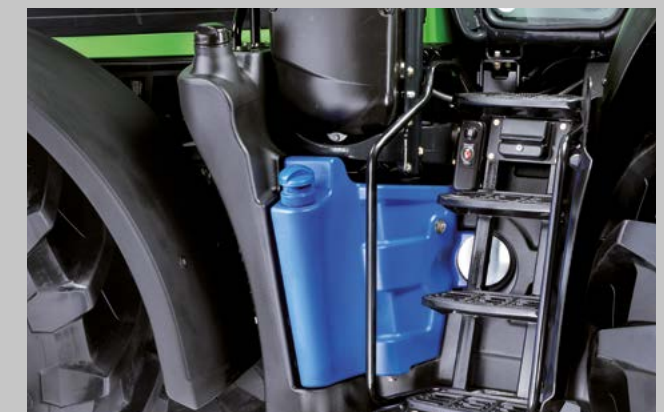
600l Diesel und 55l AdBlue reichen für mehr als einen Arbeitstag schwerer Feldarbeit. Optional: Kraftstoffvorfilter für bestes Kaltstartverhalten.
