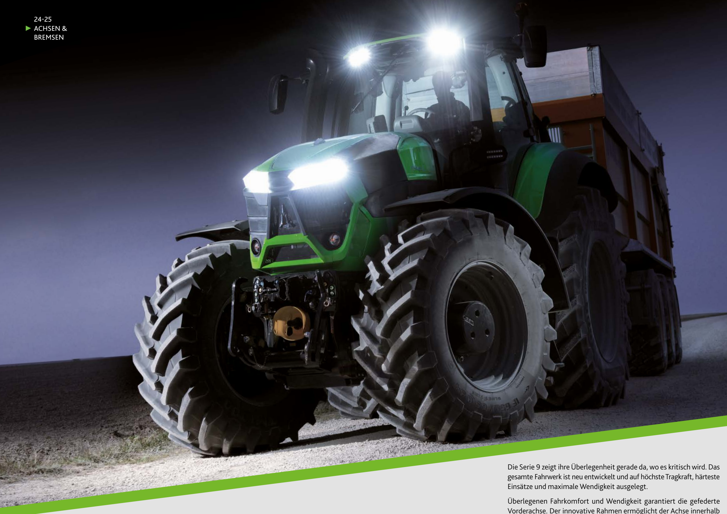
Vorderachse. Maximaler Federeffekt und ein Lenkeinschlagswinkel von bis zu 50 Grad.
