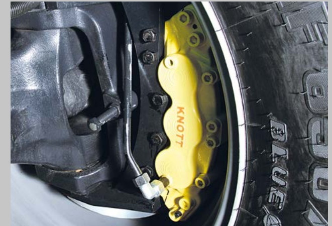
Nasse Scheibenbremsen an den Vorderachsen für extrasichere Bremswirkung (optional).
