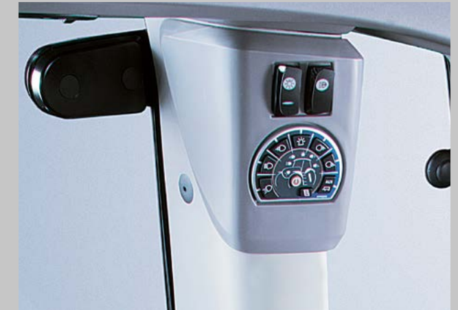
Fahrlicht, Arbeitslicht und Kabinenlicht in einem Bedienpanel zusammengefasst.
