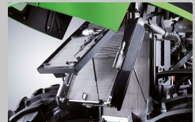
Das kompakte Kühlsystem unterstützt die Motoreffizienz und ist leicht zu warten.
