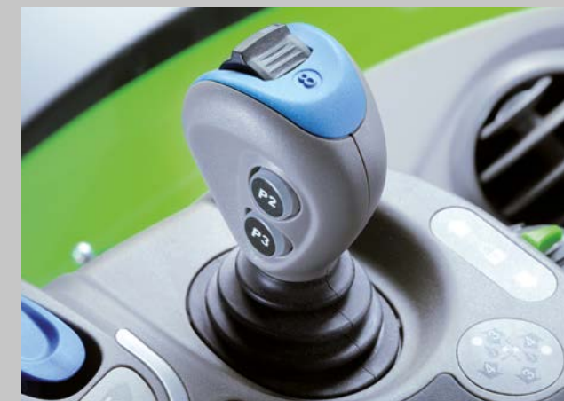
Über den Kreuzsteuerhebel mit Wippschalter lassen sich drei hydraulische Steuergeräte bedienen.
