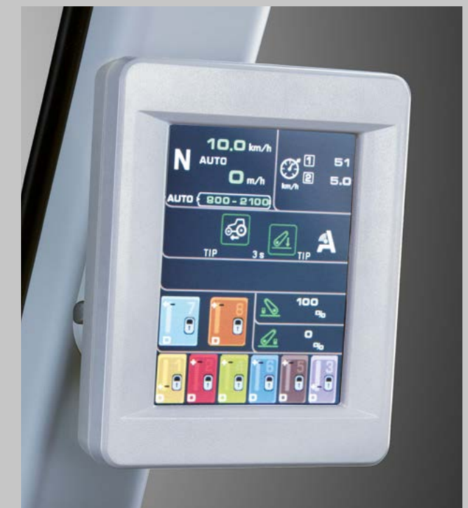
Drei Fahr- bzw. Arbeitsstrategien sind wählbar. Manuell, Automatik und PTO. Sie werden im WorkMonitor angezeigt.
