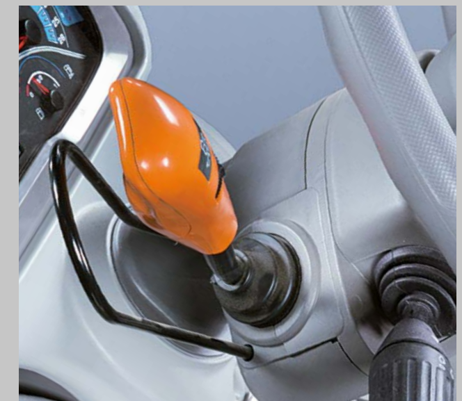
Serienmäßig: Hydraulisches Powershuttle System. Die Empfindlichkeit (Hard-Medium-Soft) wird einfach mit dem Daumen eingestellt.
