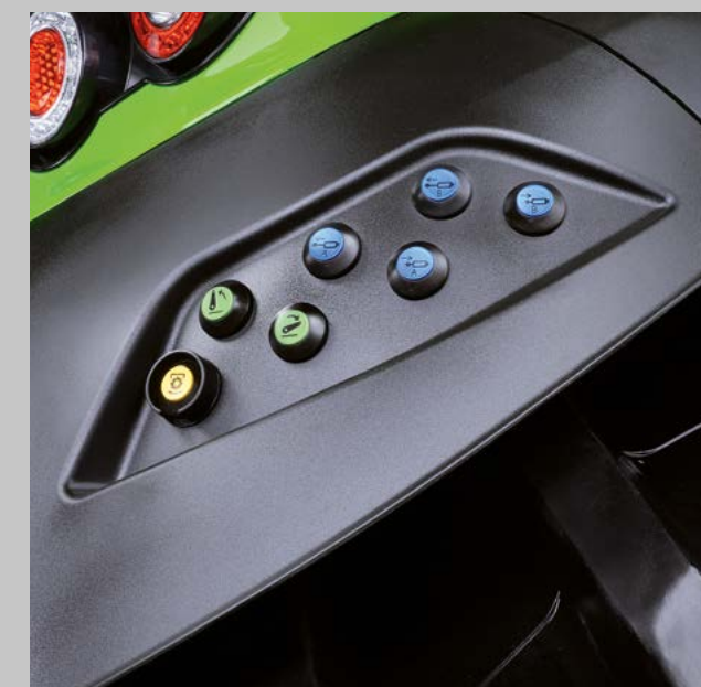
Externe Steuerung der Hydraulik- und Zapfwellenfunktionen von beiden Seiten möglich.
