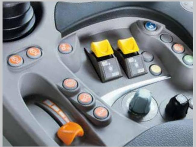
Zapfwellenbedienelemente (front-/heckseitig) und Zuschaltung sind in die Armlehne integriert...
