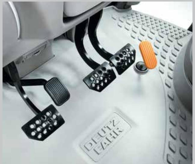
Bremskraftverstärker sorgt bereits bei leichter Pedalbetätigung für hohe Bremsleistung.
