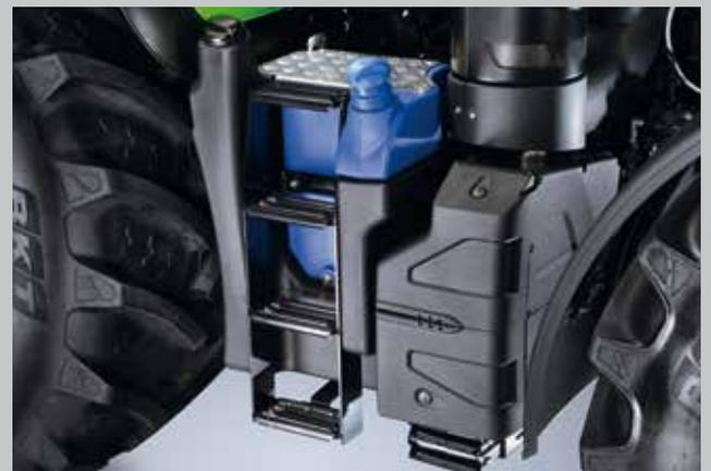
Geringerer Kraftstoff- und AdBlue-Verbrauch. 400 Liter Diesel und 50 Liter AdBlue ermöglichen lange Arbeitsphasen.
