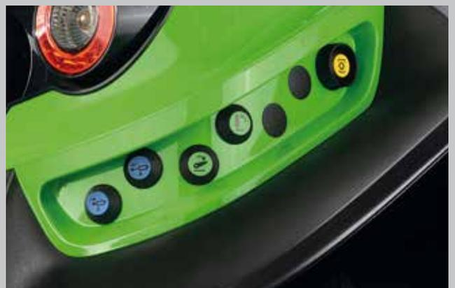
Externe Bedienung für Hydraulik, Heckkraftheber und Zapfwelle.
