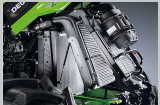
Neu konstruiertes Kühlerpaket aus Aluminium. Vollständig zu öffnen für eine leichte Wartung und einer hohen Lebensdauer.
