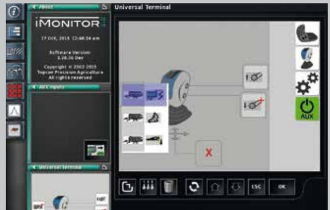
ISOBUS-Integration. Arbeitsgerätfunktionen werden über Traktortasten gesteuert.
