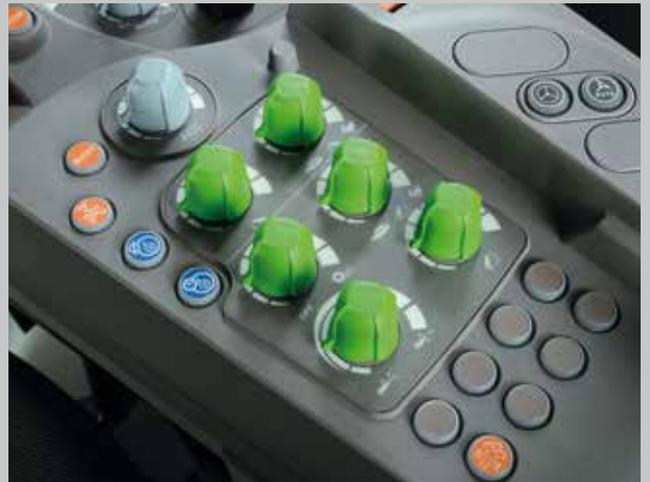
... ebenso wie die Bedienelemente des Front- und Heckkrafthebers.
