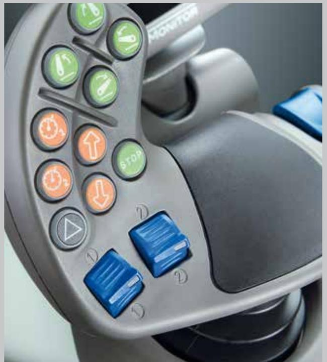
Zur Optimierung der Arbeitsabläufe können 4 Fahrgeschwindigkeiten gespeichert und wieder abgerufen werden.
