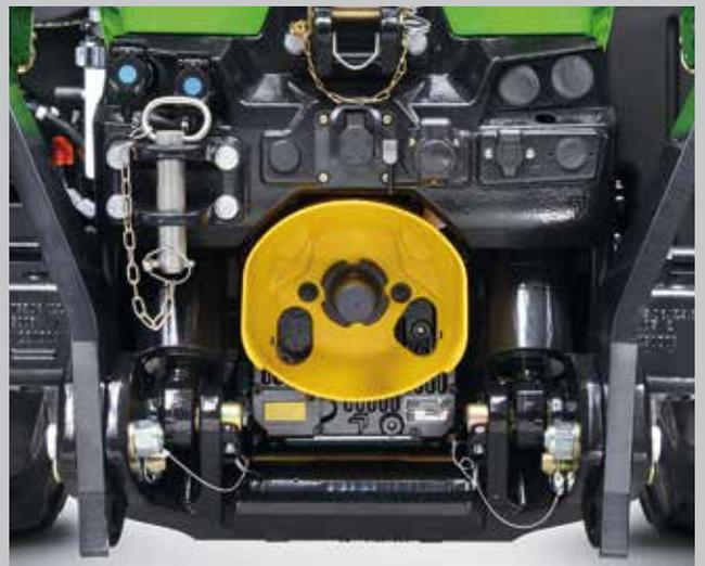
Bis zu 7 proportionale Steuerventile hinten und 2 vorne. Frontkraftheber näher am Traktor und integriert.
