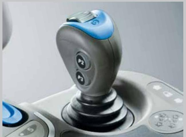
Die Hydraulikventile werden über einen Joystick mit integriertem Rändelrad angesteuert.
