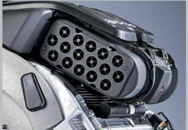
Vorreinigungssystem im Motorluftfilter: Spiralförmige Zyklonrohre und Saugschläuche scheiden 95 % des Staubs ab, bevor dieser in den Hauptfilter gelangt.
