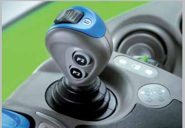
Die Hydraulikventile sind proportional steuerbar und voll auf Zeit und Menge programmierbar. Der elektronische Joystick kann programmiert werden um den Frontlader zu bedienen, weitere Traktorfunktionen können über das Rändelrad eingestellt werden.
