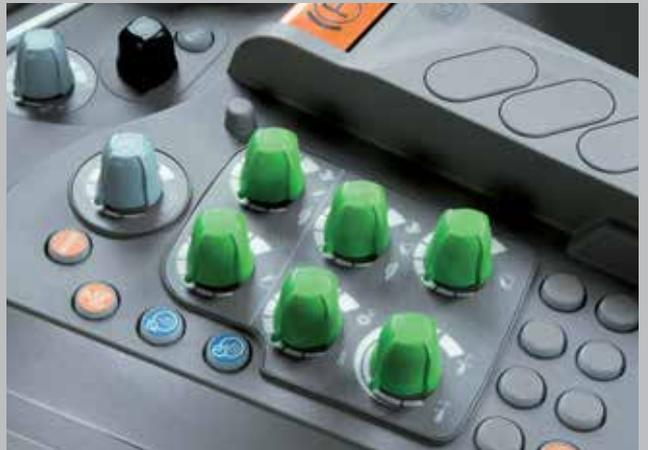
Die Feineinstellung von Frontkraftheber (nur TTV) und Heckkraftheber erfolgt über entsprechende Potentiometer in der Armlehne.
