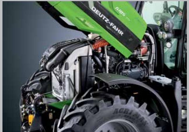
Hoch wirksames und kompaktes Kühlsystem mit Ladeluftkühler, Wasserkühler, Getriebeölkühler, Kraftstoffkühler und Kondensator.
