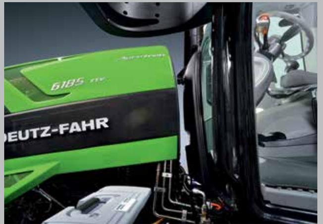
Kabine und Motorhaube sind für besseren Fahrkomfort entkoppelt.
