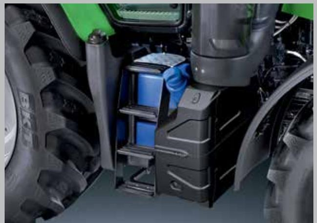
Geringerer Kraftstoff- und AdBlue-Verbrauch. 280 Liter Diesel und 35 Liter AdBlue ermöglichen lange Arbeitstage.
