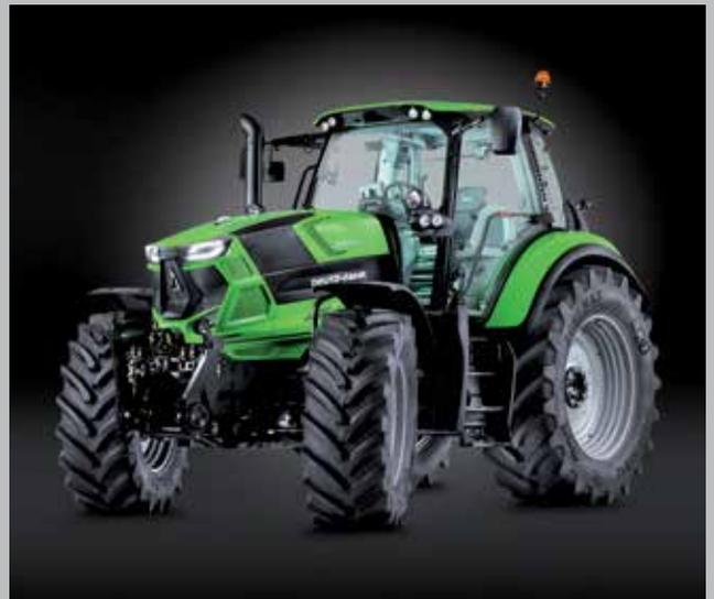
Maximal stufenlos regelbares TTV-Getriebe jetzt bis 226 PS (Modell 6215).
