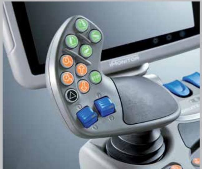
Mit einer Spitzenfahrgeschwindigkeit von 50 km/h sind die TTV-Modelle der Serie 6 echte Profifahrzeuge. Mittels zwei Knöpfen am Joystick kann der Fahrer 4 verschiedene Geschwindigkeitseinstellungen für die Feldarbeit oder auf der Straße abrufen und eine konstante Geschwindigkeit für optimale Ergebnisse aufrechterhalten.
