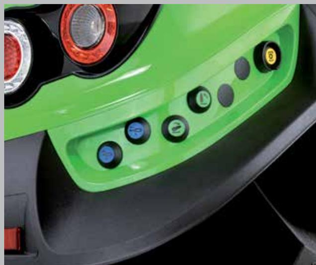
Hydraulik, Heckkraftheber und Zapfwelle lassen sich extern von jeder Seite aus leicht bedienen.
