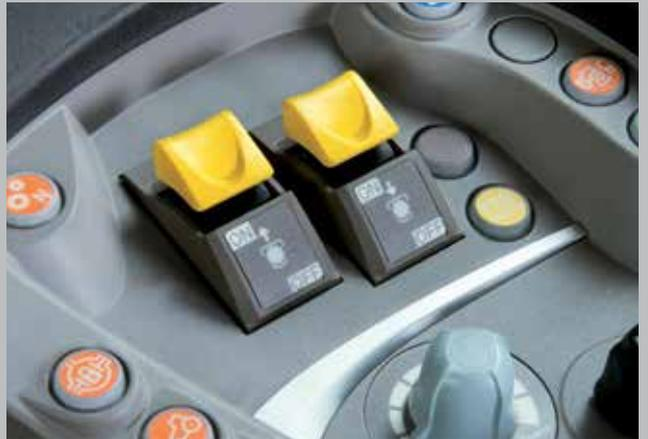
Bei allen Kabinausführungen erfolgt die Zapfwellenschaltung standardmäßig einfach und sicher per Knopfdruck.
