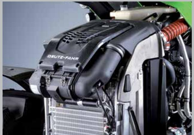
PowerCore-Technik für den Luftfilter: 20 % mehr Luftleistung im Vergleich zu Standardfiltern.
