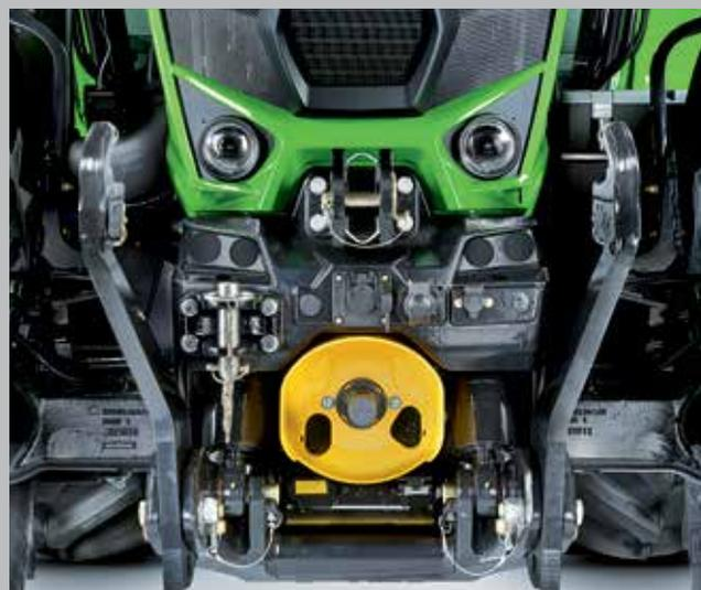
Neuer positionsgesteuerter Frontkraftheber für höhere Hubkraft (nur bei den TTV-Modellen).
