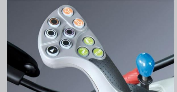
Die Bedienung der TTV-Modelle erfolgt über den neuen PowerCom S Joystick. Drei Knöpfe sind frei belegbar.
