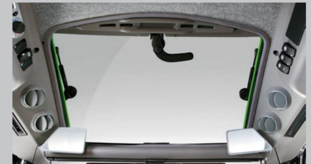
Optimierte Scheibenwischerposition an der Heckscheibe. Sorgt für beste Sicht bei Nässe und Verschmutzung. Jetzt auch mit Defrost-Funktion.
