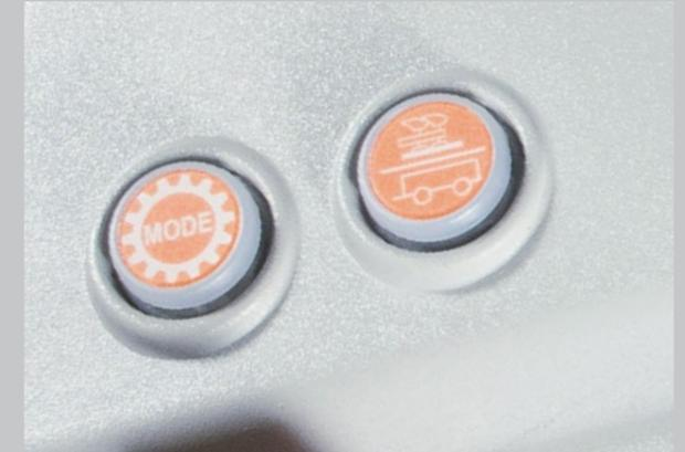
Arbeitsbereiche (FELD/TRANSPORT) elektrohydraulisch wählbar: Die FELD/TRANSPORT Gruppe kann im Stillstand gewechselt werden oder während der Traktor sich in Bewegung befindet (max. 15 km/h).
