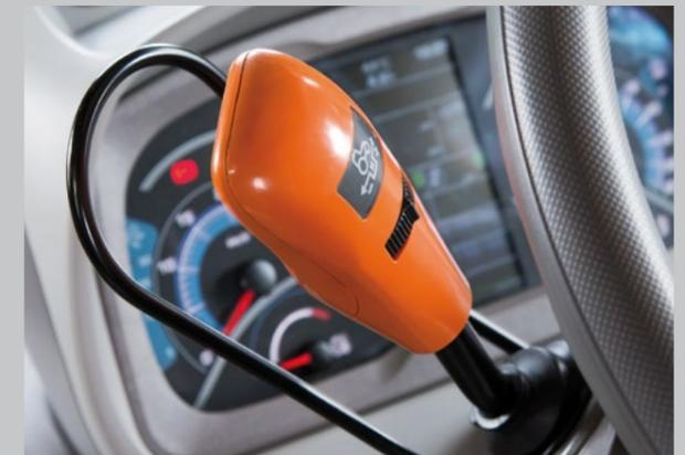
Das elektrohydraulische Powershuttle SenseClutch für präzise, stufenweise und sichere Fahrtrichtungswechsel in Bewegung und unter Last ohne Unterbrechung des Drehmomentes.
