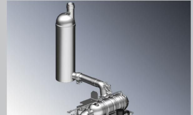
DOC, SCR und DPF (6130-6140) – die neuen Deutz 3.6 4-Zylinder Motoren sind mit modernster Abgastechnologie ausgerüstet.
