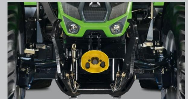
Leistungsstarker Frontkraftheber mit bis zu 2.880 kg Hubkraft. Komfortpaket mit einem Zusatzsteuerventil in der Front verfügbar.
