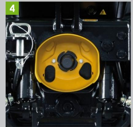
4 Für noch mehr Einsatzvielfalt ist optional eine Frontzapfwelle wählbar.
