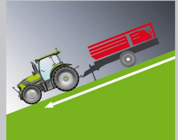
Eine hydraulische oder pneumatische Anhängerbremse sorgt für sichere Fahrt unter schwerer Last.
