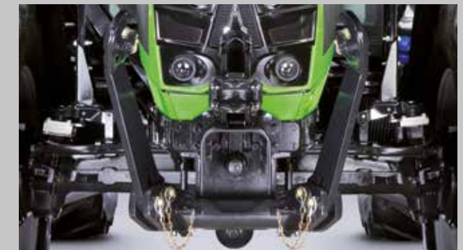
Frontanbauräum. 2100 kg Hubkraft und 1000er Zapfwelle.
