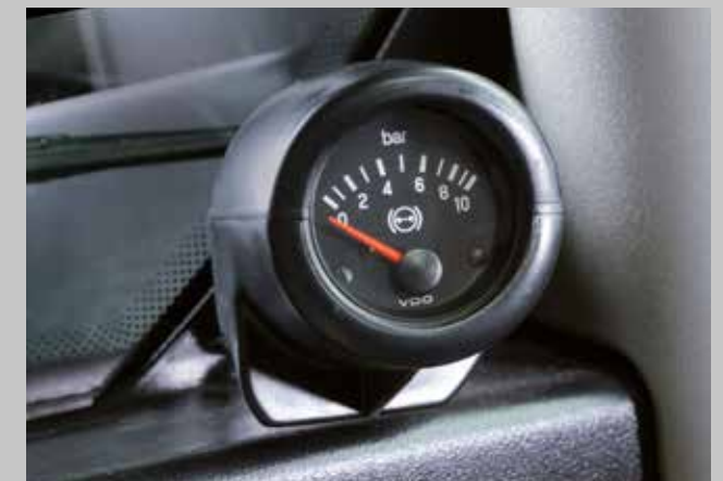
Druckluftbremsanlage (optional) für sicheres Abbremsen von Anbaugeräten.
