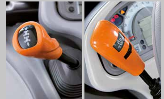
Mechanische oder elektrohydraulische in fünf Stufen einstellbare Wendschaltung – Sie haben die Wahl.
