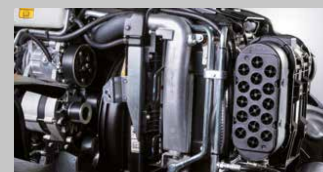
... das leicht zu reinigende Kühlsystem mit optionalem Viskolüfter.
