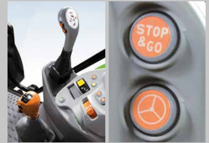
Frontlader-Joystick mit Powershift-Knöpfen, Stop&Go und SDD Schnelllenksystem und alle...
