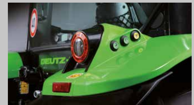
Externe Zapfwellen- und Kraftheberbedienung für leichtes Geräteankoppeln und den externen Gerätebetrieb.
