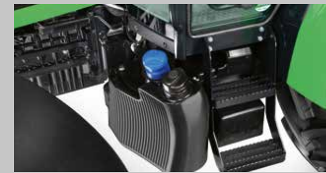
Kraftstofftank mit bis zu 145 Liter und 10 Liter ADBLue (je nach Modell) ermöglichen lange Arbeitsphasen.
