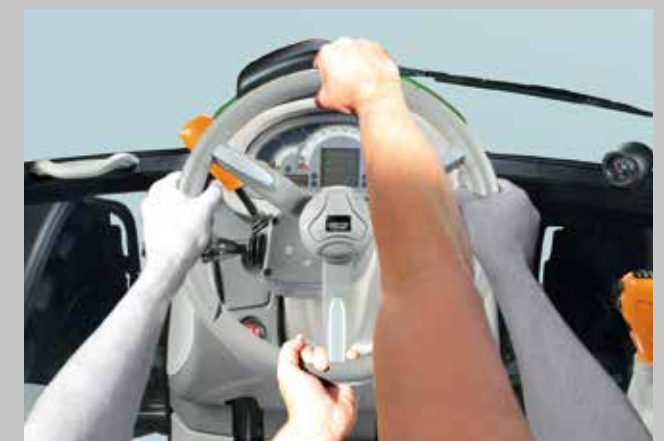
Das SDD Schnelllenksystem. Halbe Lenkraddrehung, doppelter Lenkeinschlag.
