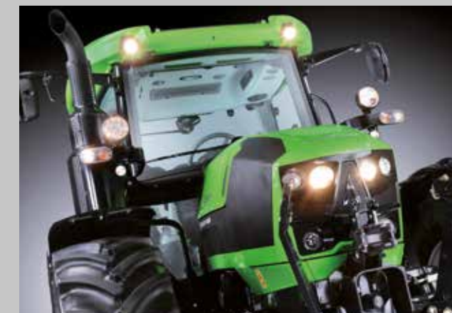
Für beste Sicht bei schlechter Sicht. Acht Arbeitsscheinwerfer im Dach und an den Seitenholmen. Zwei Arbeitsscheinwerfer in der Motorhaube.
