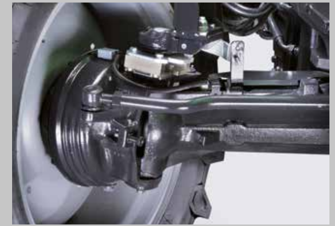
Einzigartiges Sicherheitskonzept von DEUTZ-FAHR. Separate, im Ölbad gekühlte, Scheibenbremsen an den Vorderrädern (optional).
