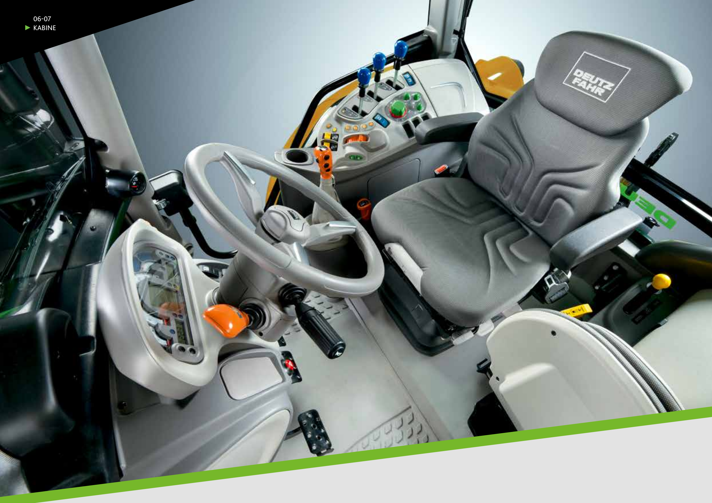
Bis zu 40% weniger Vibrationen in der Kabine. Die Hydro Silent Block Lagerung.
