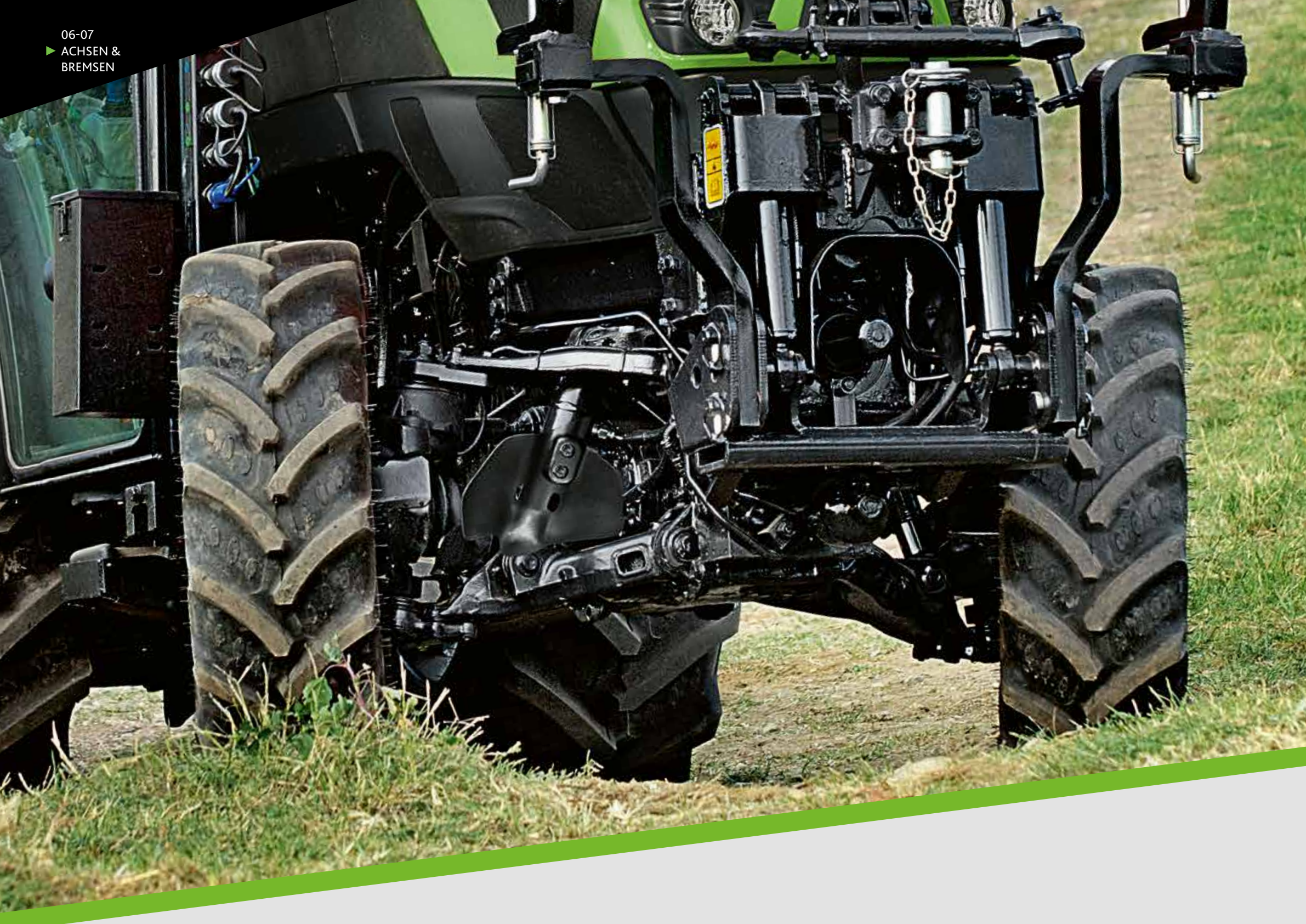
Besserer Wenderadius durch schlankere Geometrie des Vorderachsbockes.
