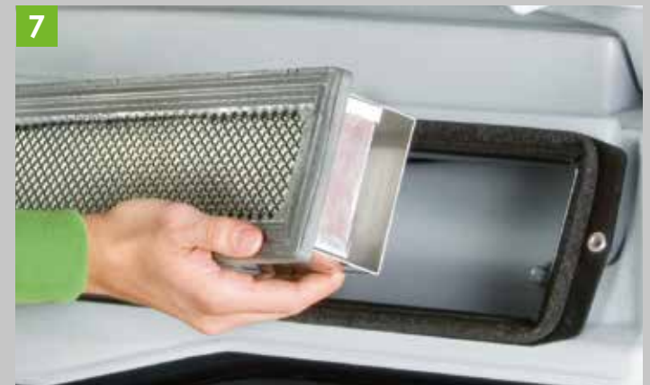
Kabinenluftfilter gegen Staub und Chemikalienbelastung. Immer saubere Luft in der Kabine.
