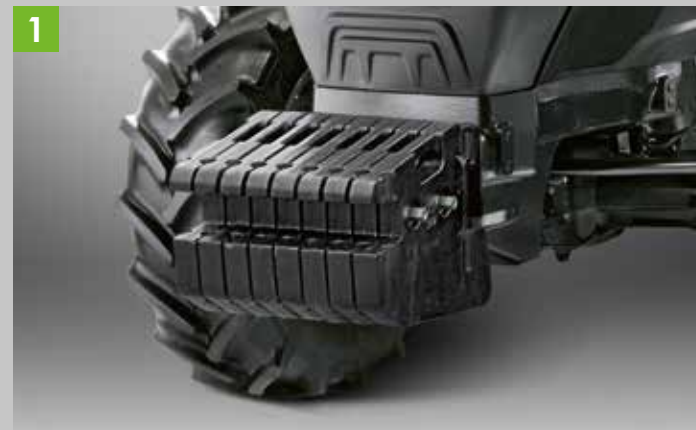
Unterschiedliche Frontgewichte für Arbeiten mit schweren Heckanbaugeräten.
