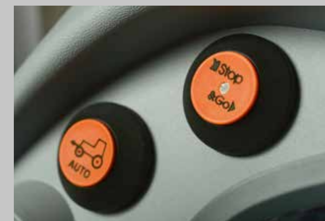
Stop&Go. Komfortables Anfahren und Anhalten ohne zu koppeln.
