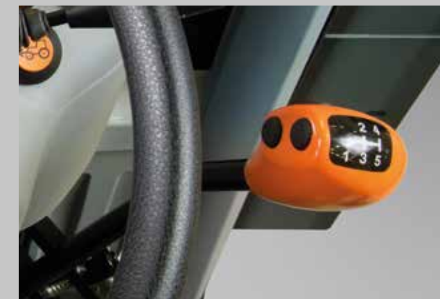
Powershift. Schalten ohne zu koppeln per Knopfdruck.
