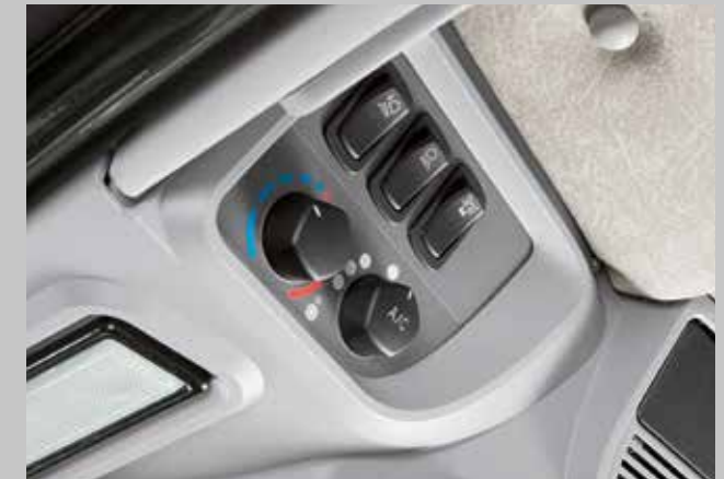
Die Bedienelemente für die Klimaanlage und die Arbeitsscheinwerfer befinden sich gut zugänglich im Dach.
