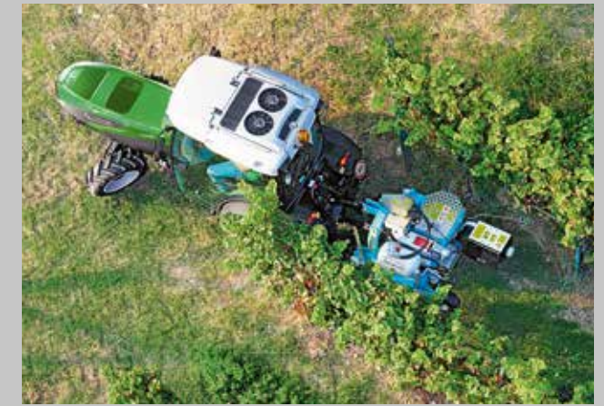
Besserer Wenderadius durch schlankere Geometrie des Vorderachsbockes.
