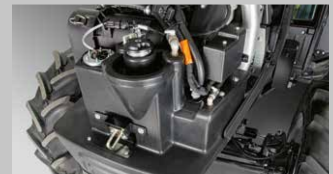
Der im Vorderachsbock integrierte Kraftstofftank ist auch bei geschlossener Motorhaube befüllbar, der Zusatztank befindet sich unterhalb des Fahrgestells.
