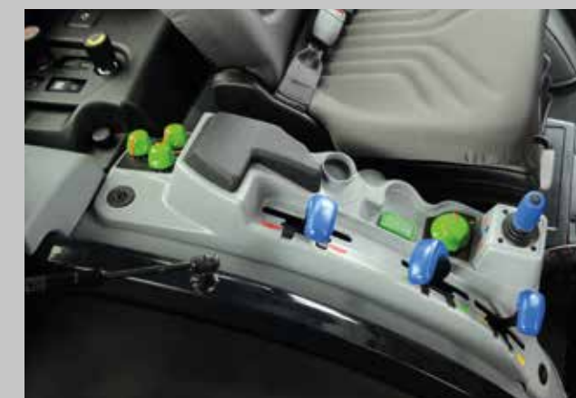
Hydraulik- und Heckkraftheberbedienung. Rechts neben dem Sitz sauber sortiert.
