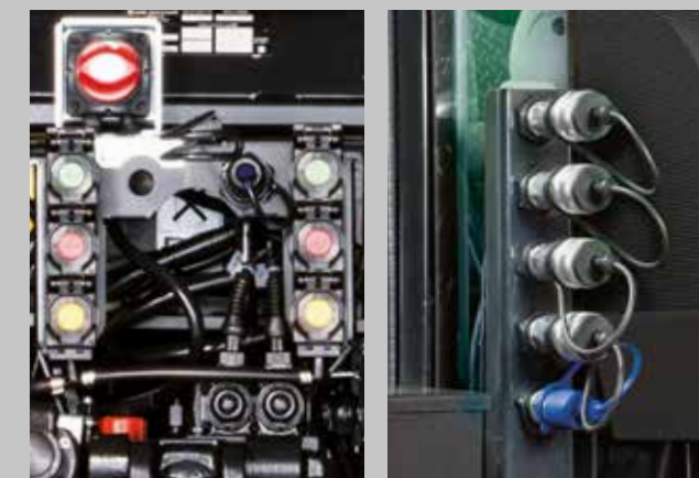
Bis zu sechs Zusatzsteuerventile im Heck- und Frontbereich.
