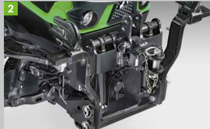
Fronthydraulik und Frontzapfwelle für effiziente Gerätekombinationen.
