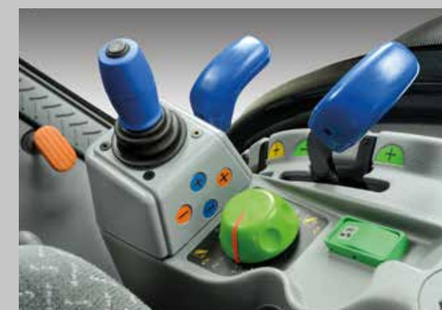
Die Bedienelemente für den Heckkraftheber und die hydraulischen Arbeitsgeräte: nah bei einander und leicht zu erreichen.
