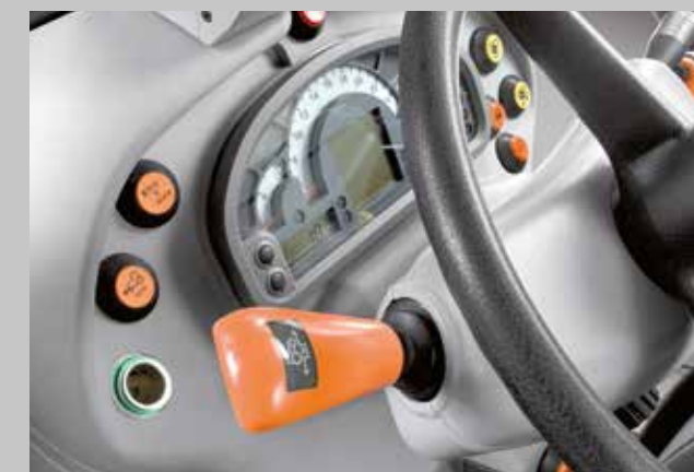
Powershuttle. Fahrtrichtungswechsel mit einem Handgriff.
