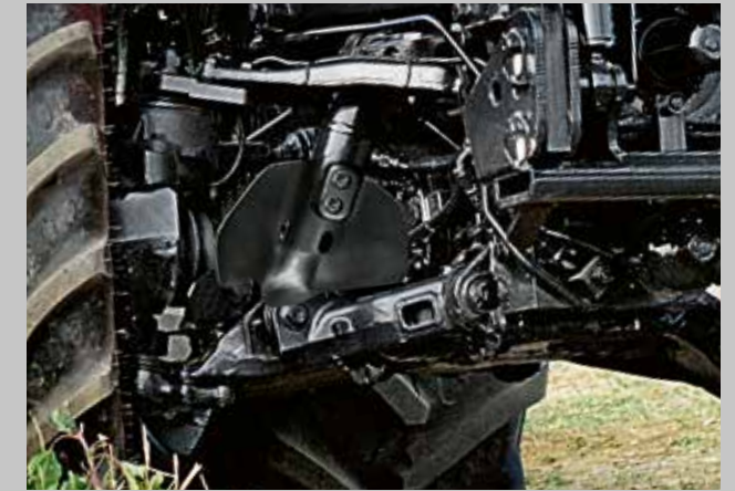
Unabhängige Federung der Vorderräder durch Einzelradaufhängung mit doppelten Querlenkern.
