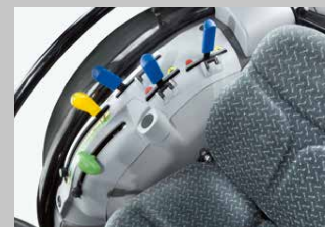
Bedienhebel für den mechanischen Heckkraftheber, funktionell und ergonomisch.
