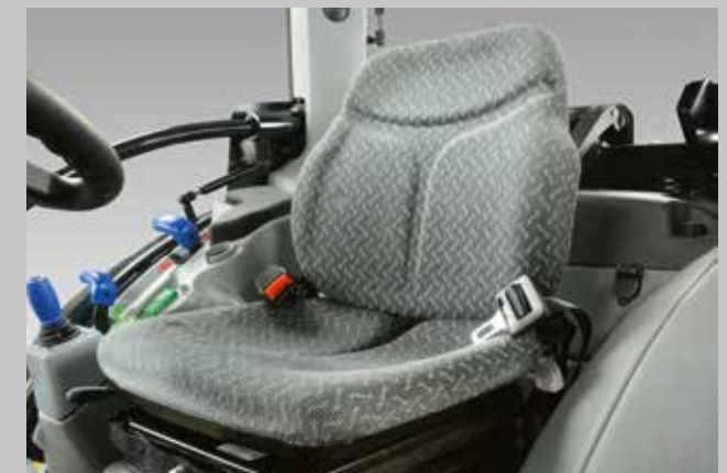
Verschiedene Sitzvarianten mit pneumatischer oder mechanischer Federung und unterschiedlichen Einstelloptionen stehen zur Auswahl.
