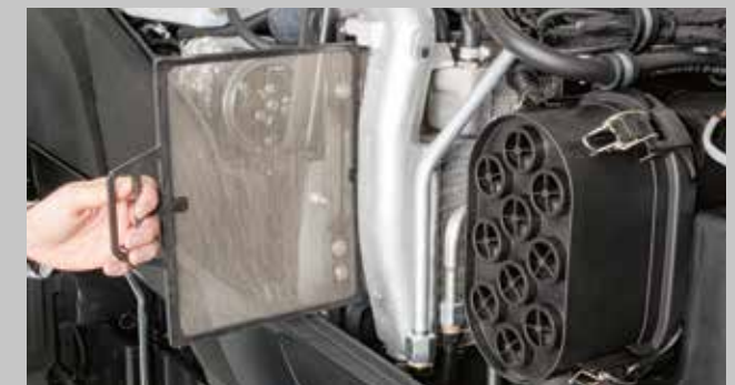
Das große neu gestaltete Kühlpaket, die verbesserte Luftführung und der Powercore Luftfilter unterstützen die Motoreffizienz.
