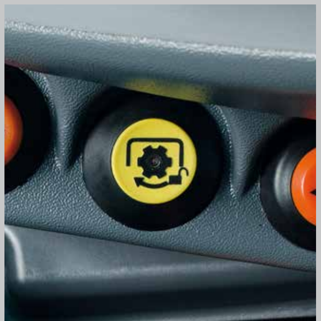
Die elektrohydraulische Zapfwellenbedienung ist gut zugänglich.
