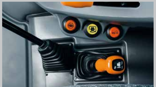
Elektrohydraulische Zuschaltung von Zapfwelle, Allradantrieb und Differentialsperre (LS und GS).
