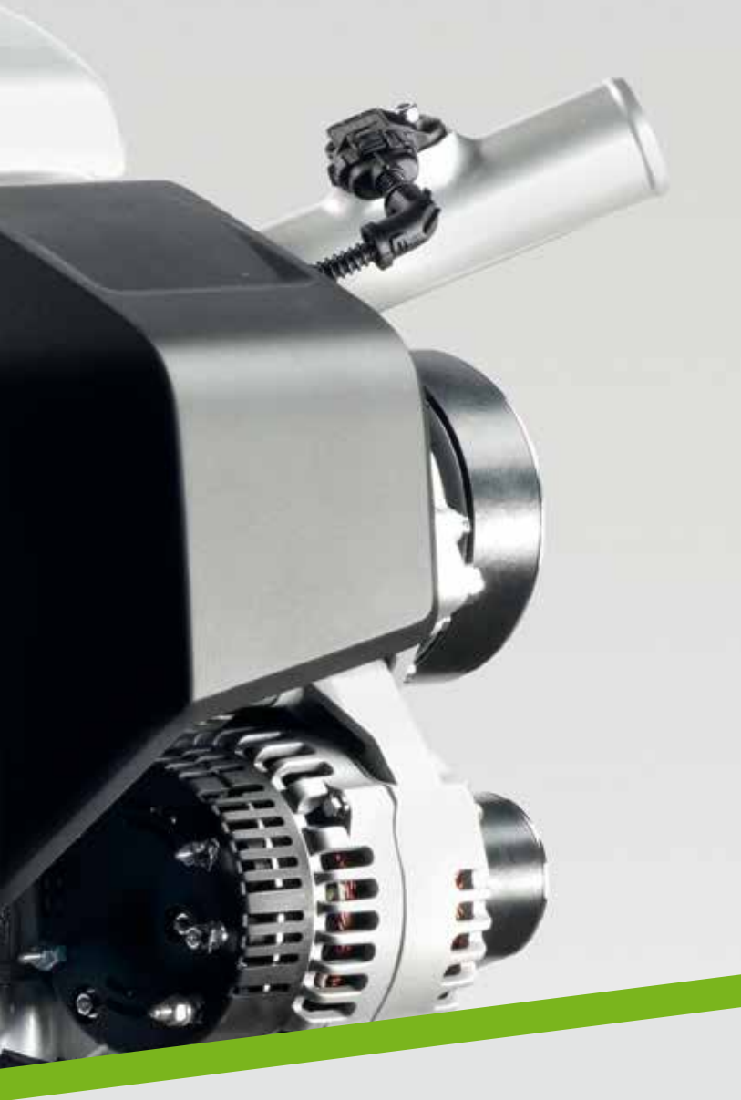
Das kompakte DOC-System (Diesel Oxidation Catalyst) benötigt keine spezielle Wartung.
