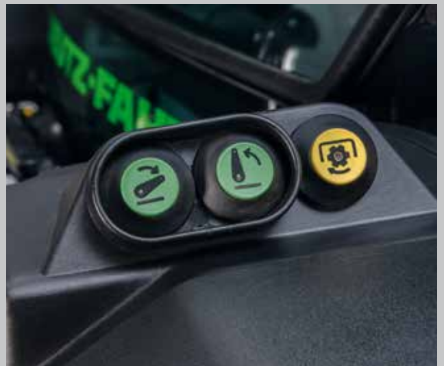
Bequeme Bedienung des Heckkrafthebers und der Zapfwelle vom hinteren Kotflügel aus.
