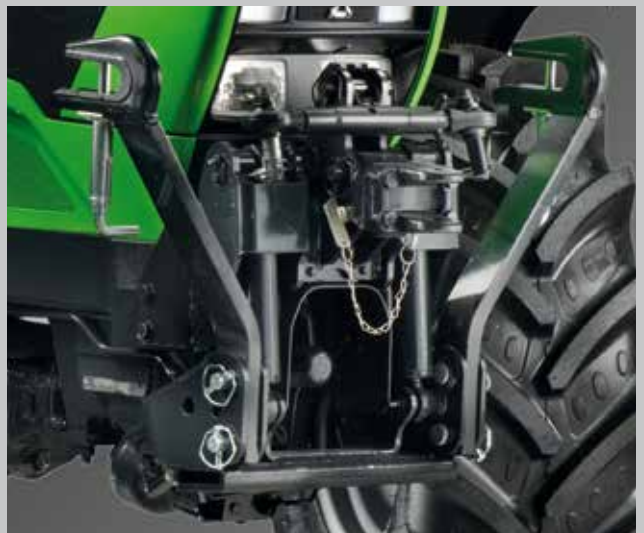
Auf Wunsch können die LS- und GS-Modelle mit Frontkrafthebern ausgestattet werden.
