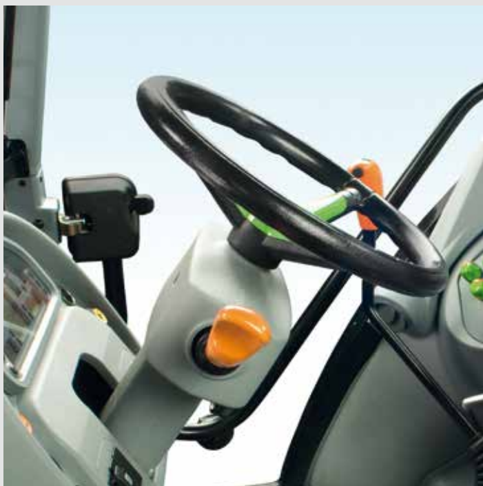
Das im Neigungswinkel verstellbare Teleskopenkrad kann beliebig an die Größe des Fahrers angepasst werden.
