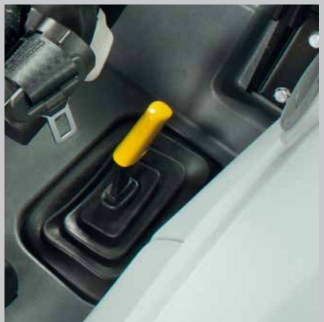
Eine einfache Lösung – die mechanische Zapfwellenbedienung der Ecoline-Modelle.
