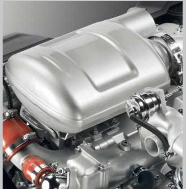
Das kompakte DOC-System (Diesel Oxidation Catalyst) benötigt keine spezielle Wartung.
