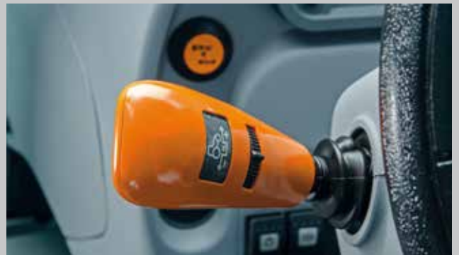
PowerShuttle-Hebel mit SenseClutch und Stop&Go-Schalter.
