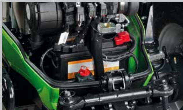
Der Batterietrennschalter befindet sich im Frontbereich des Traktors.
