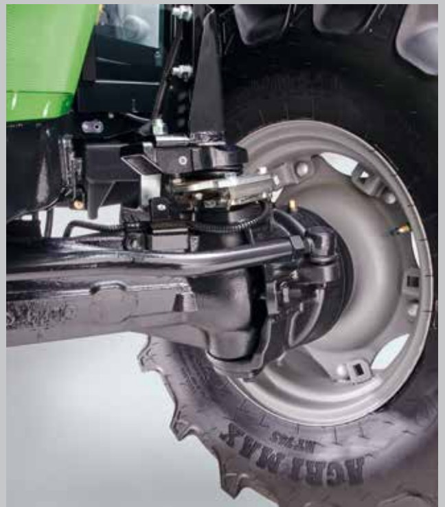
Vierradbremse mit Scheibenbremsen im Ölbad.
