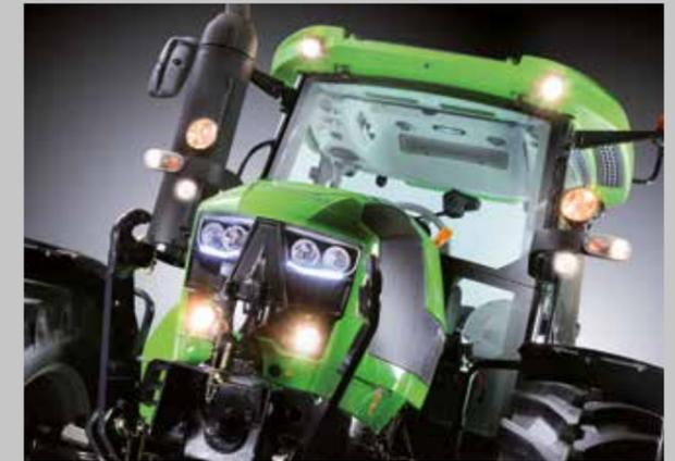
Das Scheinwerferpaket. Für beste Sicht bei schlechter Sicht. Acht Arbeitsscheinwerfer im Dach und an den Seitenholmen. Zwei Arbeitsscheinwerfer und zwei LED-Leuchten in der Motorhaube.
