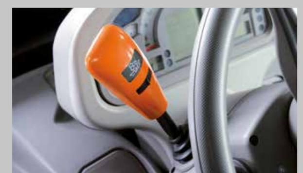
Powershuttle serienmäßig. Elektrohydraulische Wendeschtaltung in 5 Stufen einstellbar.
