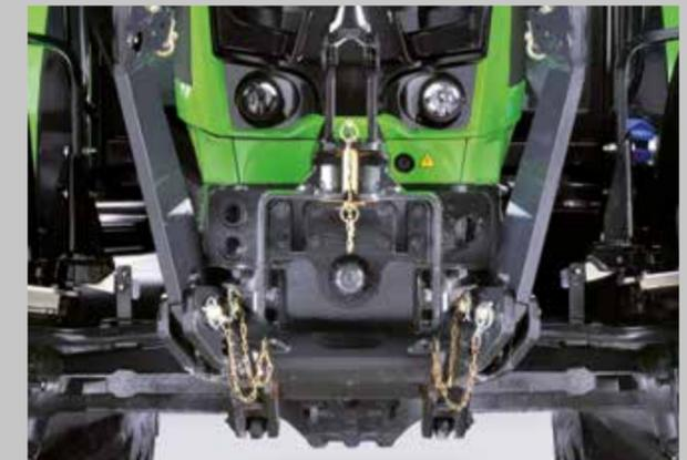
Frontanbauräum. 2100 kg Hubkraft und 1000er Zapfwelle.
