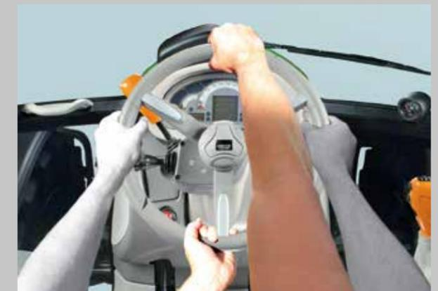
Das SDD Schnelllenksystem. Halbe Lenkraddrehung, doppelter Lenkeinschlag.
