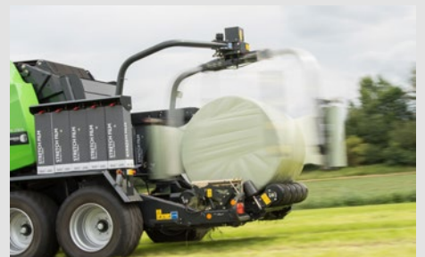
Umstieg auf konventionelle Wicklung für eine 100%ige Bedeckung.
