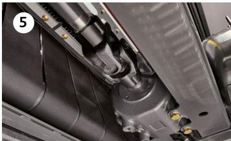
Schwere Kardanwellen/Kreuzgelenke in Antriebsachsen
