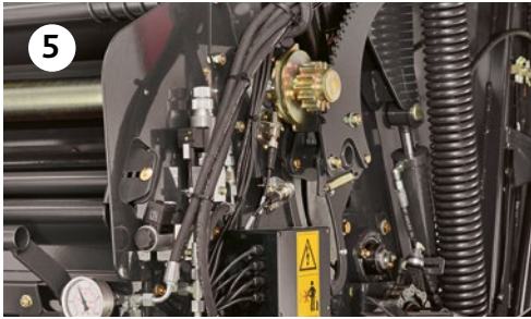
Proportionalventil für Dichteregelung von der Fahrerkabine aus
