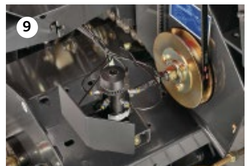
Beka Max Permanent-Kettenölsystem
