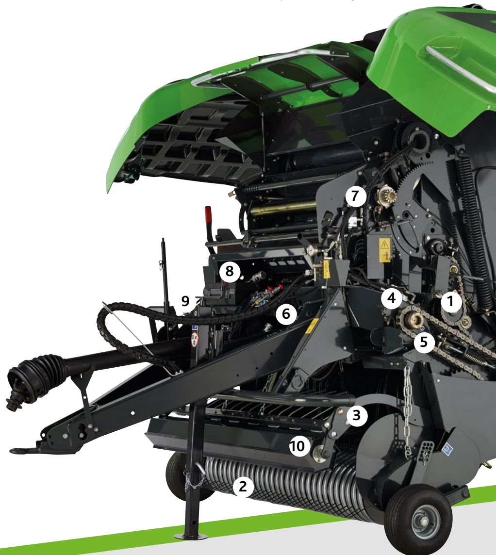
Separate Messerabschaltung/Absenkung des Schneidbodens vom Fahrersitz aus
