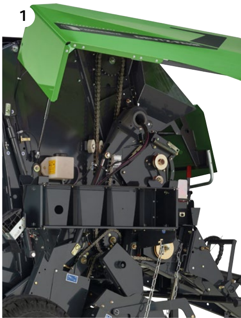
Robuster Antrieb mit hochwertigen IWIS-Ketten
