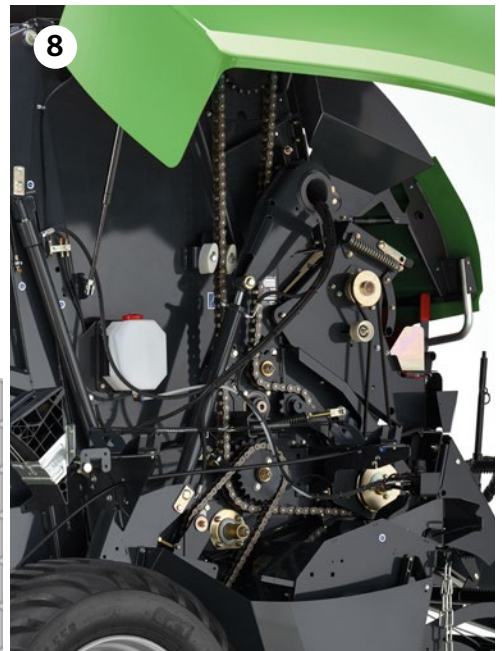
Robuster Antrieb mit hochwertigen IWS-Ketten + 1 1/4-Zoll-20HB-Hauptantriebswelle mit Hartchromstiften
