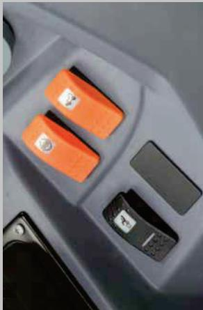
Wahlweise mechanische oder elektrohydraulische Zuschaltung von Allradantrieb und Differenzialsperre.
