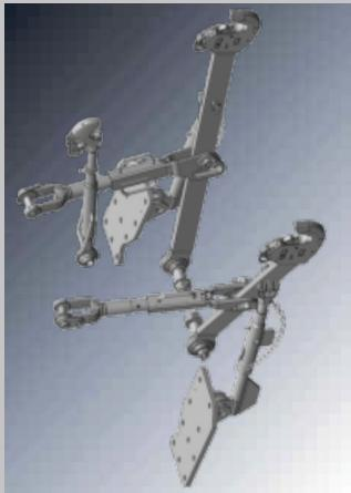
Heckkraftheber mit Kat.-II-Schnellkupplern und 3.500 kg Hubkraft.
