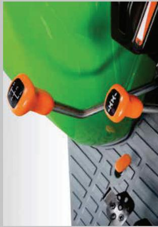
Getriebeschaltung, Handgas, Motordrehzahlspiecher, Heckkraftheber und Hydrauliksteuerung griffgünstig rechts vom Fahrer.
